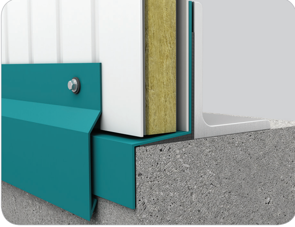
Damlalık Detayı / Drip Box Detail
