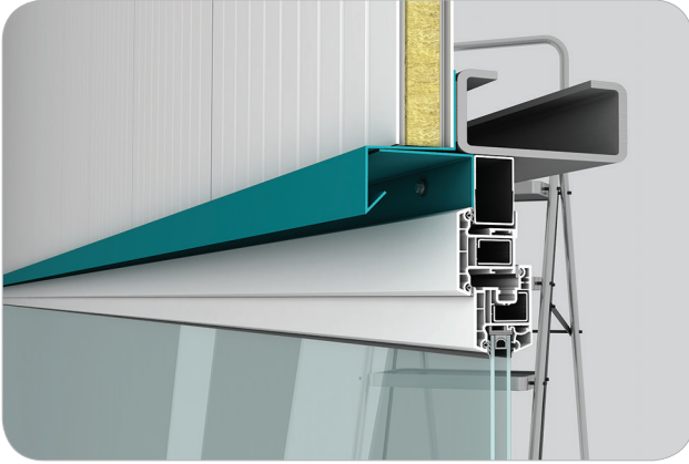
Panel Birleşim Detayı-1 / Panel Connection Detail-1
